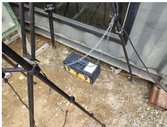
ติดตั้งเครื่องตรวจวัดฝุ่นละออง เครื่องวัดเสียงและเครื่องวัดแรงสั่นสะเทือนช่วงรื้อถอน
