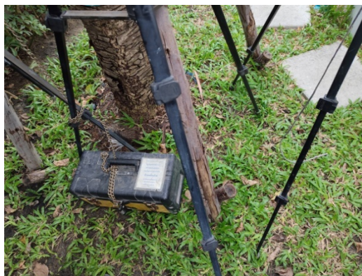
ติดตั้งเครื่องตรวจวัดฝุ่นละออง แบบ Gravimetric method เครื่องตรวจวัดเสียง
