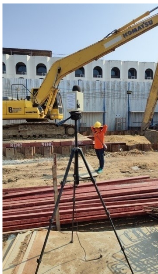
ติดตั้งเครื่องตรวจวัดฝุ่นละออง แบบ Gravimetric method ก้าวชมลพิษภายในพื้นที่โครงการ CO , NO 2 , SO 2 , THC เครื่องตรวจวัดเสียง และเครื่องวัดแรงสั่นสะเทือน ย้ายไปตามจุดที่มีการทำเสาเข็ม ภายในพื้นที่โครงการ
