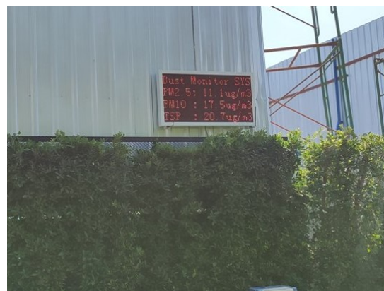
ติดตั้งเครื่องตรวจวัดฝุ่นละออง เครื่องวัดเสียงและเครื่องวัดแรงสั่นสะเทือนช่วงรื้อถอน
