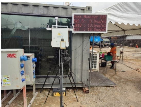
ติดตั้งเครื่องตรวจวัดฝุ่นละออง เครื่องวัดเสียงและเครื่องวัดแรงสั่นสะเทือนช่วงรื้อถอน
