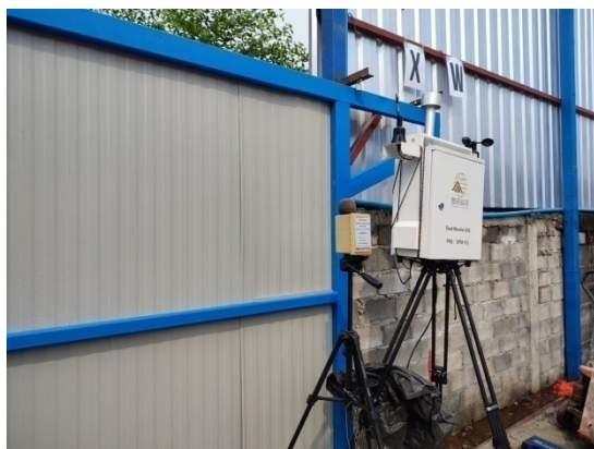
ติดตั้งเครื่องตรวจวัดฝุ่นละออง เครื่องวัดเสียงและเครื่องวัดแรงสั่นสะเทือนช่วงรื้อถอน
